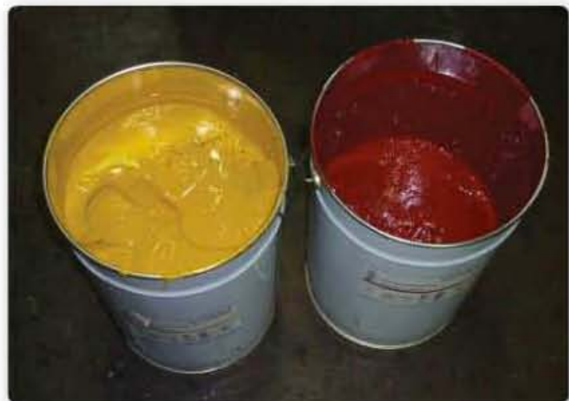
Figura 23. Las propiedades de la tinta tienen relación con la calidad de la impresión: tanto el color como el cuerpo, el tack, la resistencia al roce, el brillo, el secado, el fijado y la capacidad de emulsión inciden en los resultados obtenidos.
