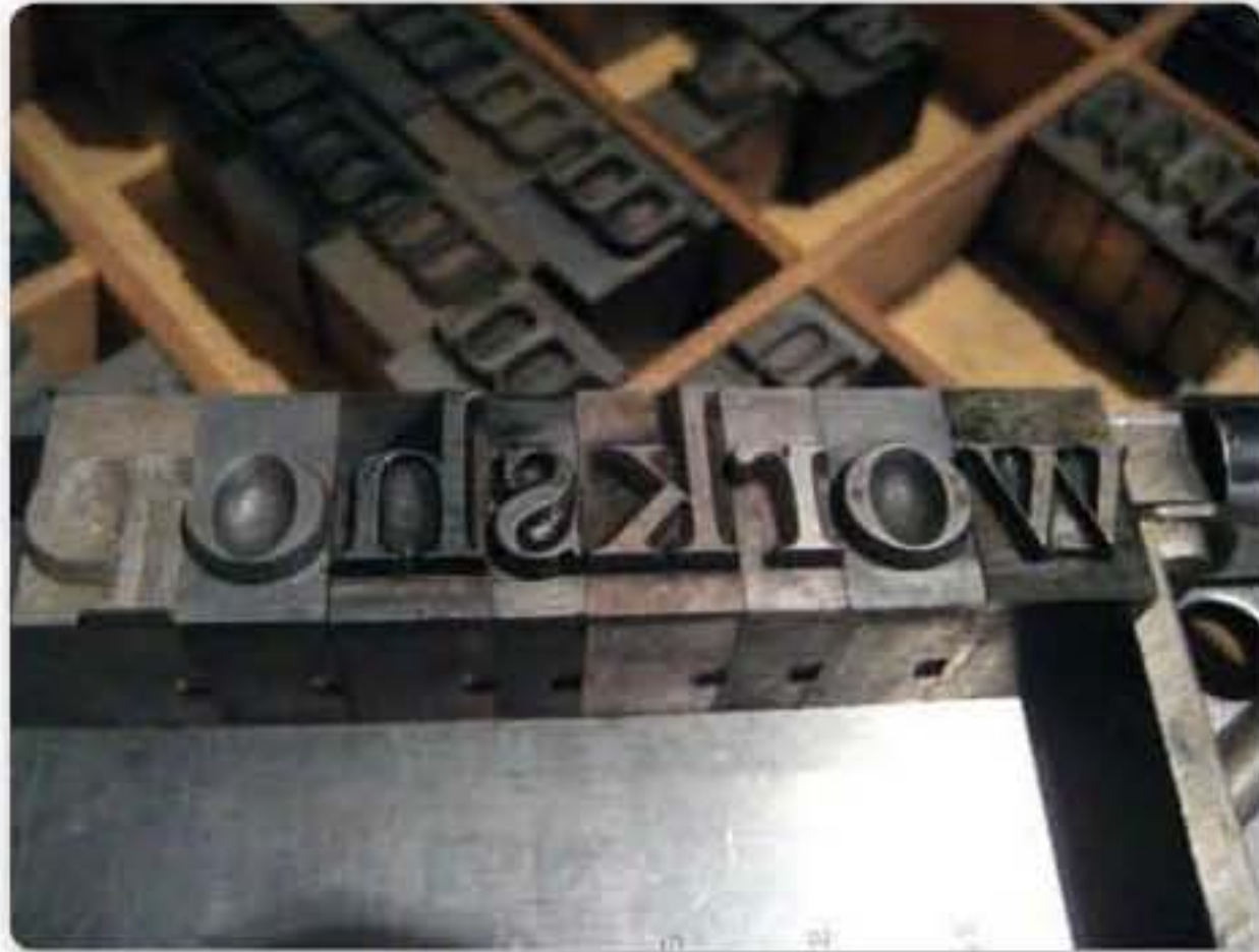
Figura 2. Los tipos móviles poseen hendiduras ( cran ) en su extremo inferior que permiten engancharlos en un mismo sentido, a fin de inmovilizarlos en el componedor.
