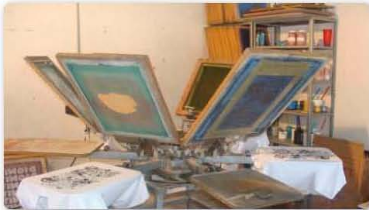
Figura 26. Una disposición muy práctica es la de pulpo o calesita, que posee varias estaciones de impresión para imprimir a varios colores rápida y eficazmente.
