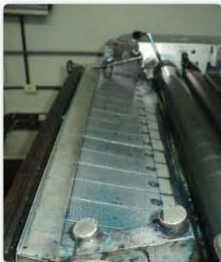
Figura 24. Los tinteros convencionales se gradúan de forma manual, mientras que en los automáticos se realiza a través de un panel de mando.
