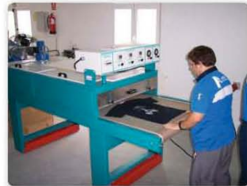
Figura 27. En serigrafía manual y semiautomática se imprimen remeras, gorras, mochilas, carteles, señalética, circuitos impresos, bolígrafos, reglas, almanagues y electrodomésticos.
