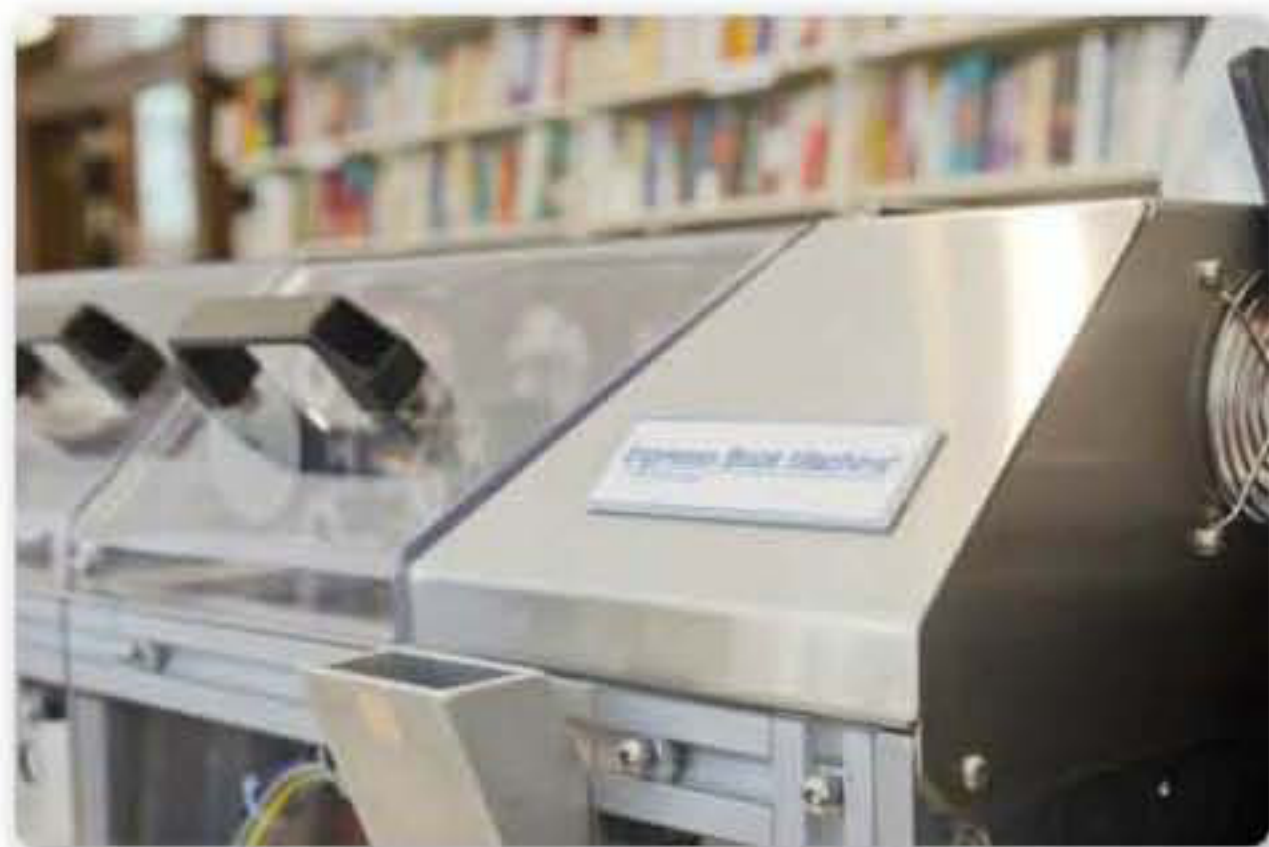
Figura 6. Máquinas como la Espresso Book Machine permiten imprimir un libro de 300 páginas (en blanco y negro) en 6 minutos, perfectamente encuadernado y con un acabado final muy similar al de la impresión offset habitual.
